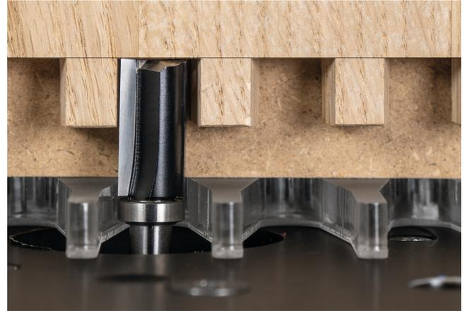
Abbildung 6: Konterprofil fräsen
