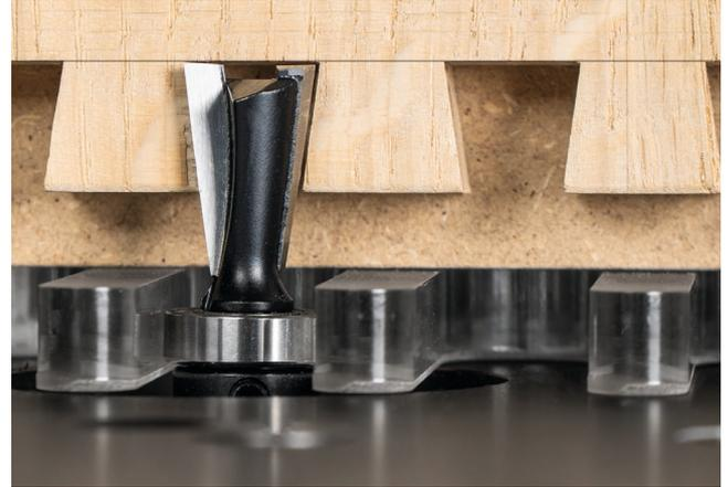
Abbildung 4: Das Kugellager läuft beim Fräsen der Schwalbenschwanzzinken an der Schablone entlang.
