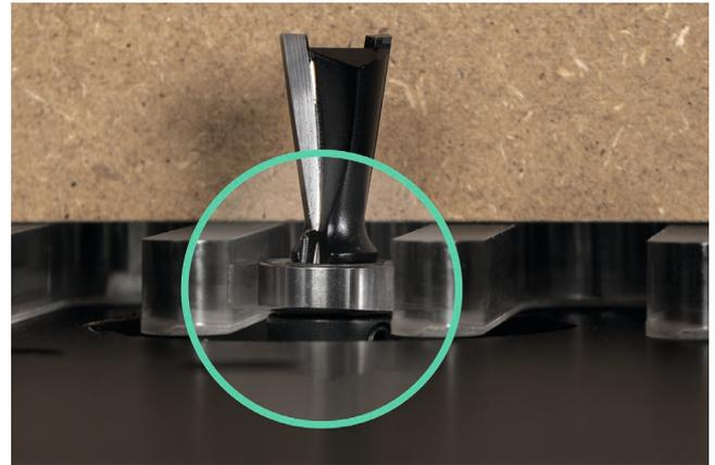
Abbildung 2: Fräserhöhe einstellen
