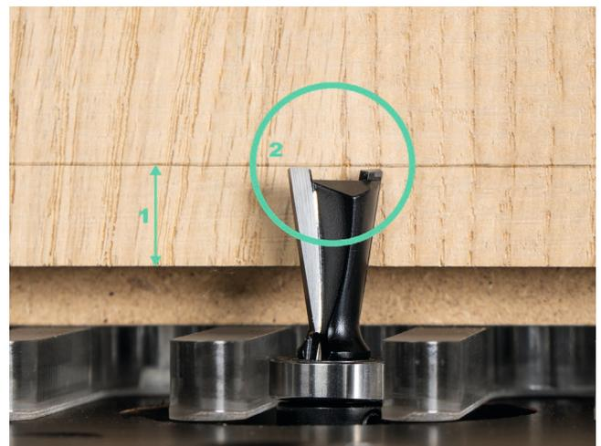
Abbildung 3.2: Werkstückpositionierung und Markierung für die Schwalbenschwanzzinken
